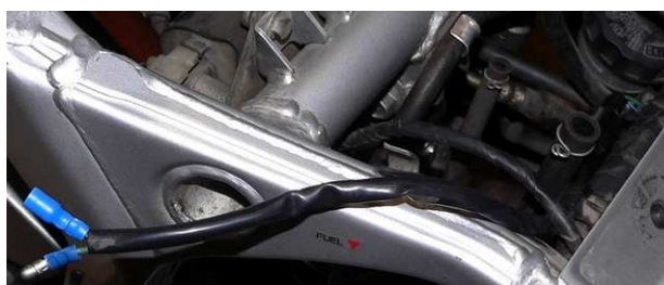
Câble électrique récupéré sur la pompe d'origine, avec cosses de connexion pour la pompe Facet (fil bleu/noir : + ; fil vert : -)
