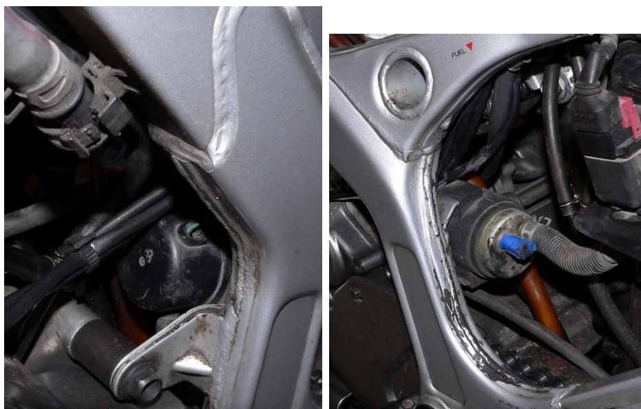
Emplacement de la pompe d'origine
