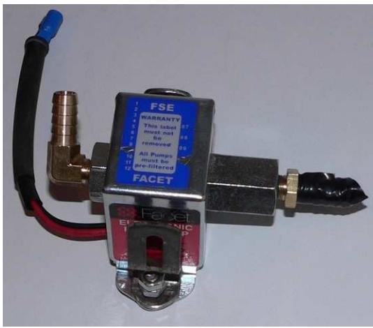
Pompe avec ses pattes de fixation et position de la sortie coudée. La fixation et l'étanchéité des raccords sont réalisés avec de la Loctite "Frein Filet" Les fils électriques de la pompe sont protégés par une gaine caoutchouc.
