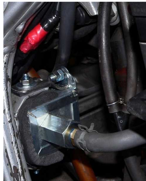
La pompe est plaquée sur le cadre et l'isolent thermique en caoutchouc réalise la fonction silentbloc. On notera le scotch électrique (rouge et noir dessous) réalisant l'étanchéité des raccords avec les cosses.
