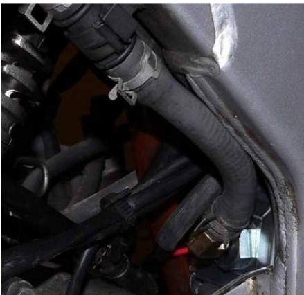
Couper la durite d'alimentation d'essence pour l'ajuster parfaitement en sortie de pompe.
